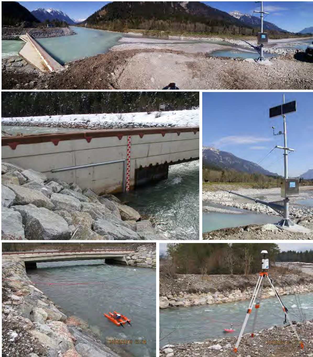
Abbildung 15: oben – Panoramabild des Lech im Bereich der Geschiebefälle, links Drosselbauwerk, rechts Messmast mit Ausleger und Radar zur Wasserstandserfassung; Mitte – Drosselbauwerk und Messmast für die Wasserstandsmessung im Einlauf zur Geschiebefälle mit Geräteträger, Solar-Stromversorgung und Videokamera; unten – Kalibrierfahrt (Drosseldurchfluss) mittels ADCP und GPS Station (Quelle: HD Tirol)
