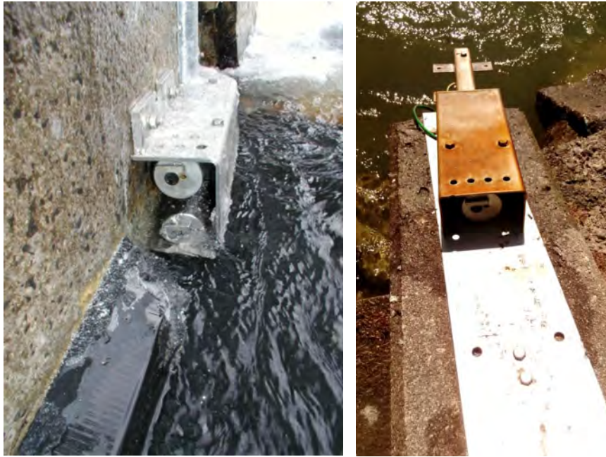
Abbildung 3: Messung der Trübung mit einer elektronischen Trübungssonde, links – am Pegel Vent/Rofenache, rechts – am Pegel Tumpen/Ötztaler Ache (Quelle: HD Tirol)
