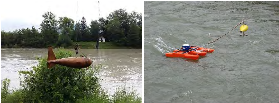
Abbildung 7: linkes Bild – amerikanischer Sampler (US-P61), rechtes Bild – ADCP-Messung (Stream-Pro); Quelle: HD Tirol
