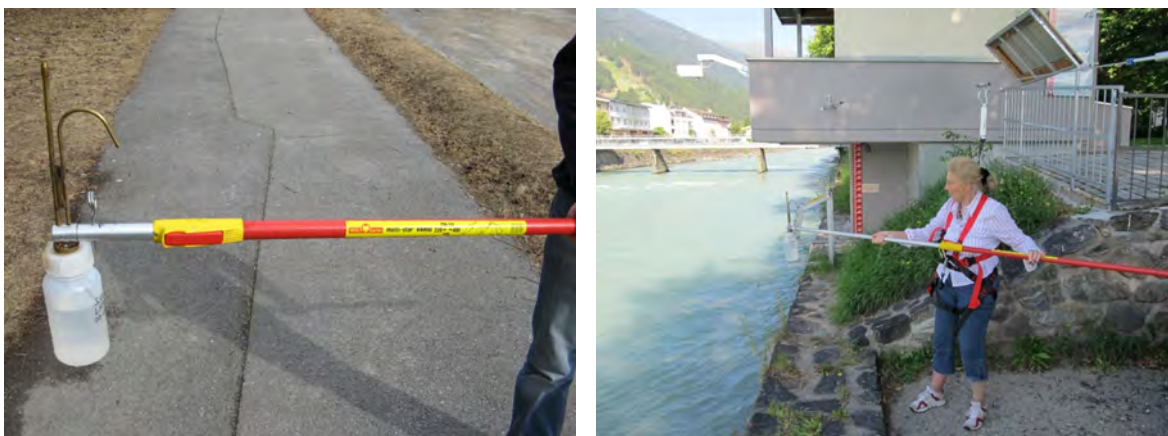
Abbildung 5: Entnahme einer Einpunktprobe mittels Stange und Einlaufrohr an der Flaschenöffnung der Probenflasche; bei der Probennahme – wie allgemein bei Arbeiten an Pegelstellen – sind die entsprechenden Schutzmaßnahmen (z. B. persönliche Schutzausrüstung, Seilsicherungen) zu berücksichtigen (Quelle: HD Tirol)
