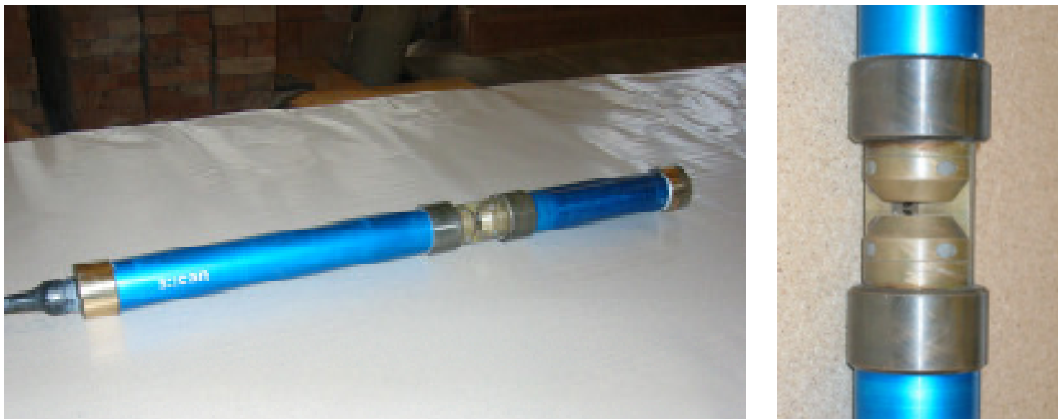
Abbildung 32: links: Spectro::lyser™ der Firma s::can, rechts: Messpfad des Spectro::lyzers (Fotos: Bittner, 2008)
