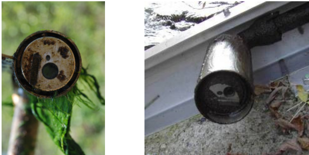
Abbildung 4: Biofouling an Sonden (Foto links: Wakolbinger, Foto rechts: Kerschbaumsteiner)
