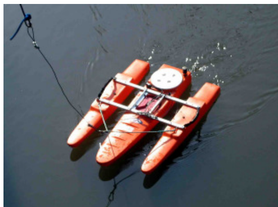
Abbildung 33: Geräteträger „Trimaran“ des ADCP-Gerätes „Workhorse Rio Grande ZedHed“ (Foto: Haimann, 2007)
