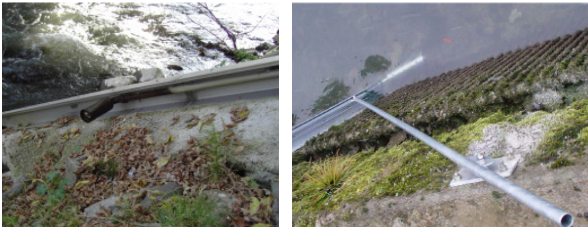
Abbildung 3: links: Schienenkonstruktion für Solitax ts-line; Feldbach/Raab (Foto: Kerschbaumsteiner) rechts: Klappkonstruktion für Solitax ts-line; Steyr/Enns (Foto: Altenhofer, 2006)
