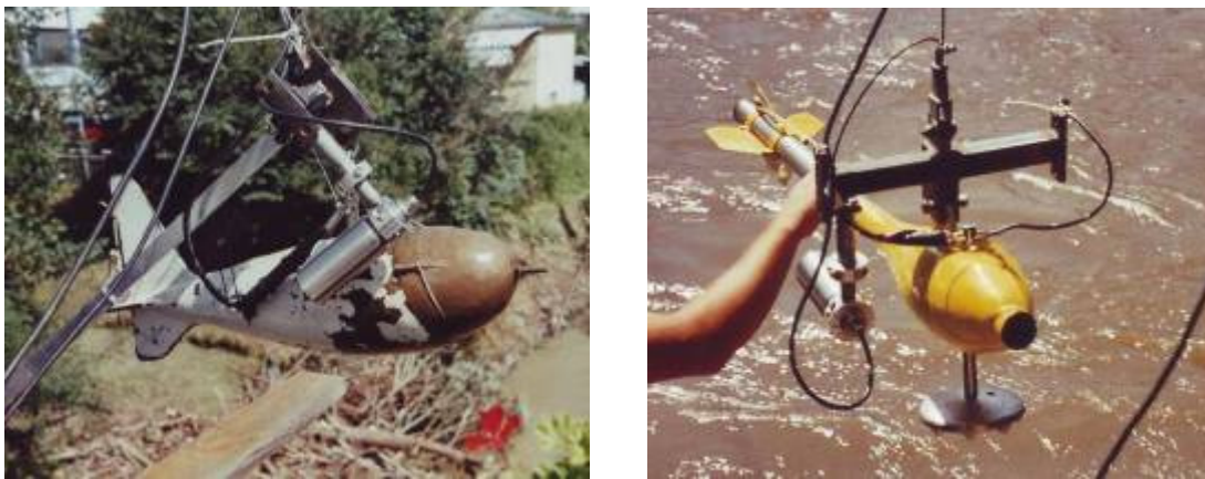
Abbildung 2: Trübungssonde an Probenentnahmegesetz (links) bzw. an Gewichtsstück des Seilflügels (rechts) (Fotos: Stimpfl)
