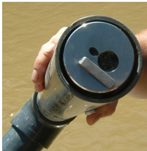
Abbildung 31: Sonde Solitax ts-line in Schutzrohr und mit Wischer (Foto: Hauer, 2007)
