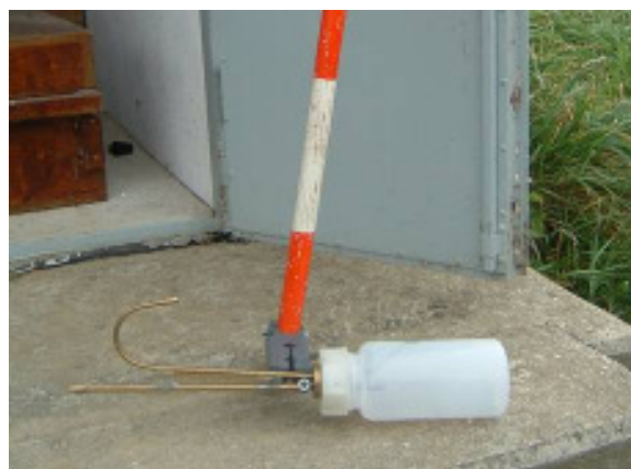
Abbildung 26: Probennehmer mit Einlaufrohr an der Stange (Hauer, 2007)
