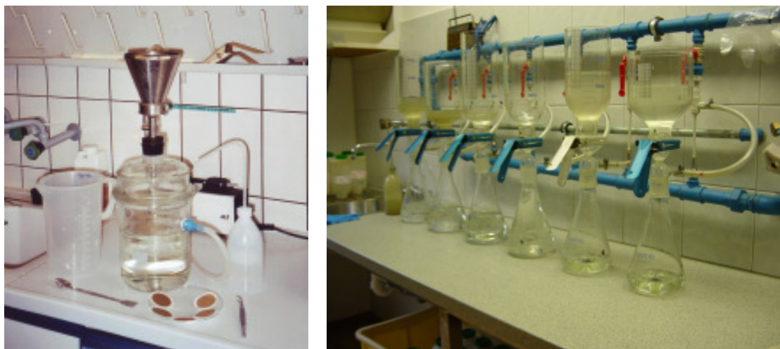
Abbildung 10: Filtriergerät mit Zubehör und Vakuumpumpe im Hintergrund (Foto links: Stimpfl, 2006); Vakuumpfiltrationsanlage der Verbund AHP (Foto rechts: Wagner, 2006)
