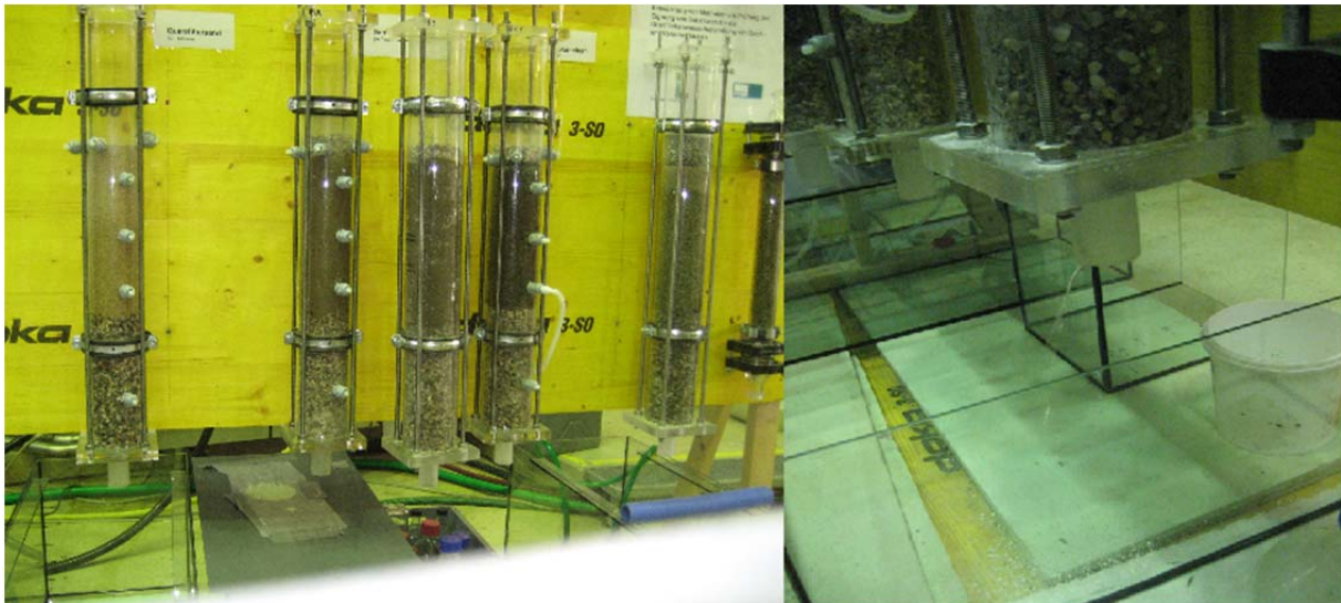
Abbildung 11: links: mit Filtermaterialien befüllte Plexiglassäulen; rechts: Auffangbehälter der Abflüsse
