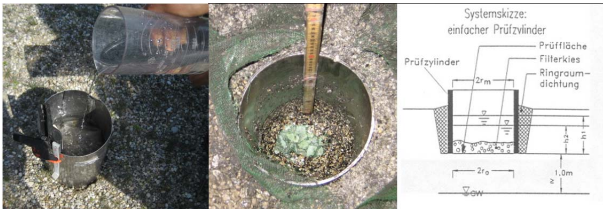
Abbildung 13: links und mittig: Infiltrationsversuche mit Einzelring-Infiltrometer, rechts: Systemskizze Prüfzylinder laut ÖNORM B 4422-2
